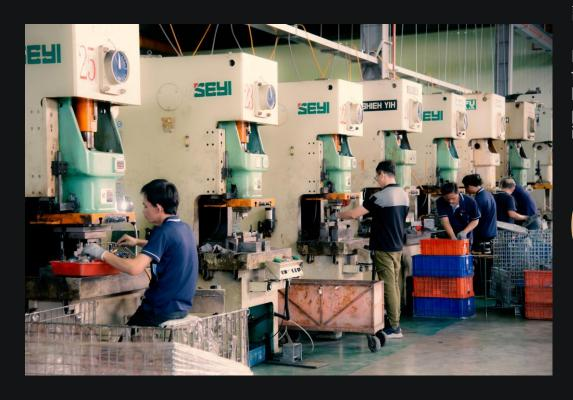
恩澤精密科技有限公司備有各式噸位油壓、沖壓沖床,最高噸位數達1000噸油壓沖床;另外更有其他模具、治具製作相關設備,得生產各式工業零組件及模具、治具。
