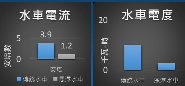
根據實測試據顯示，「恩澤節電效能水車增氧機」使用時耗電率僅為一般水車的26%。在養殖魚塭實際使用上，也證實只需一般水車用電量的30~50%。
